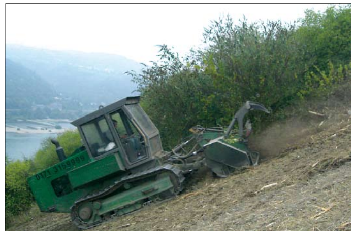
Abb. 21: Kettenraupe mit Forstmulchergerät
